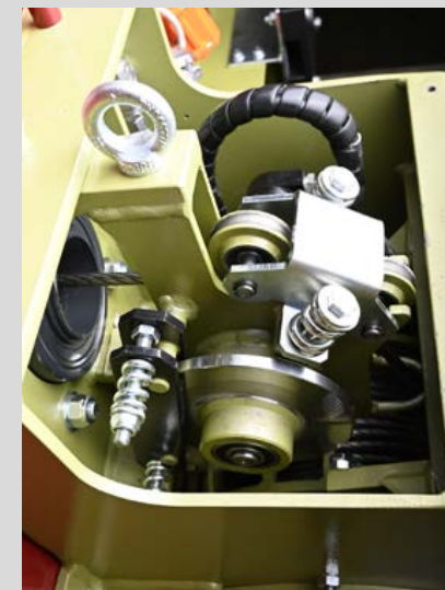
Hydraulická odvíjecí kladka
