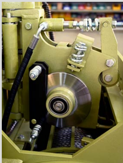
■ Hydraulická odvíjecí kladka
