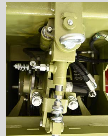
■ Hydraulická odvíjecí kladka
